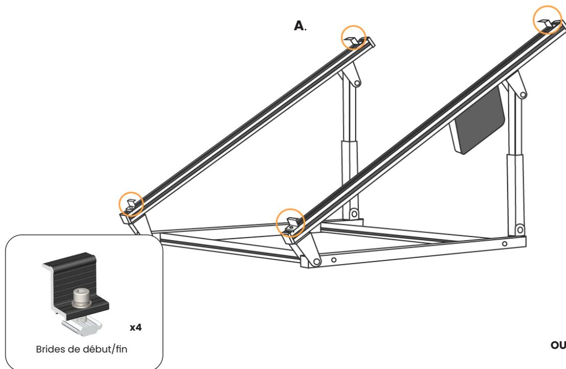
A. Placez correctement le support de fixation sur un sol plat.
